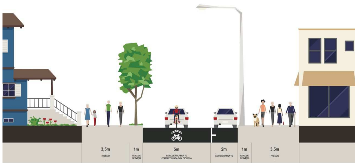
Figura 39: Perfil viário padrão da Via Local - Sentido Único (TIPO 39)
