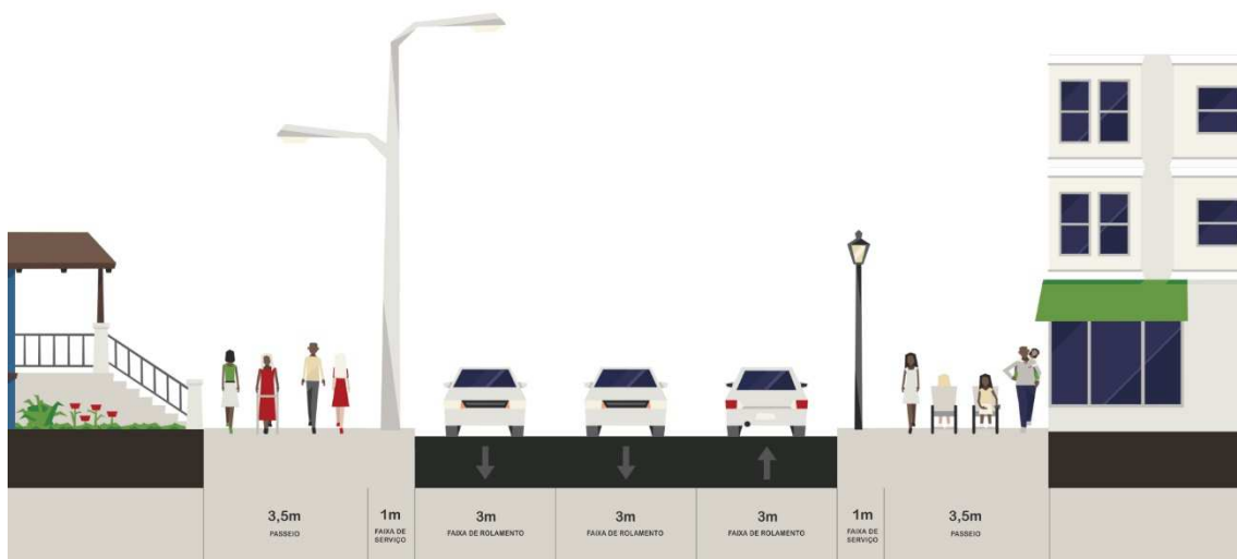
Figura 35: Perfil viário padrão da Via Coletora 2 - Sentido Duplo (TIPO 35)
