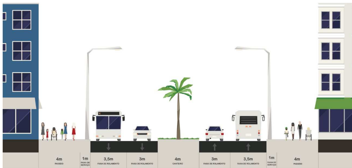
Figura 9: Perfil viário padrão da Via Arterial - Sentido Duplo (TIPO 9)
