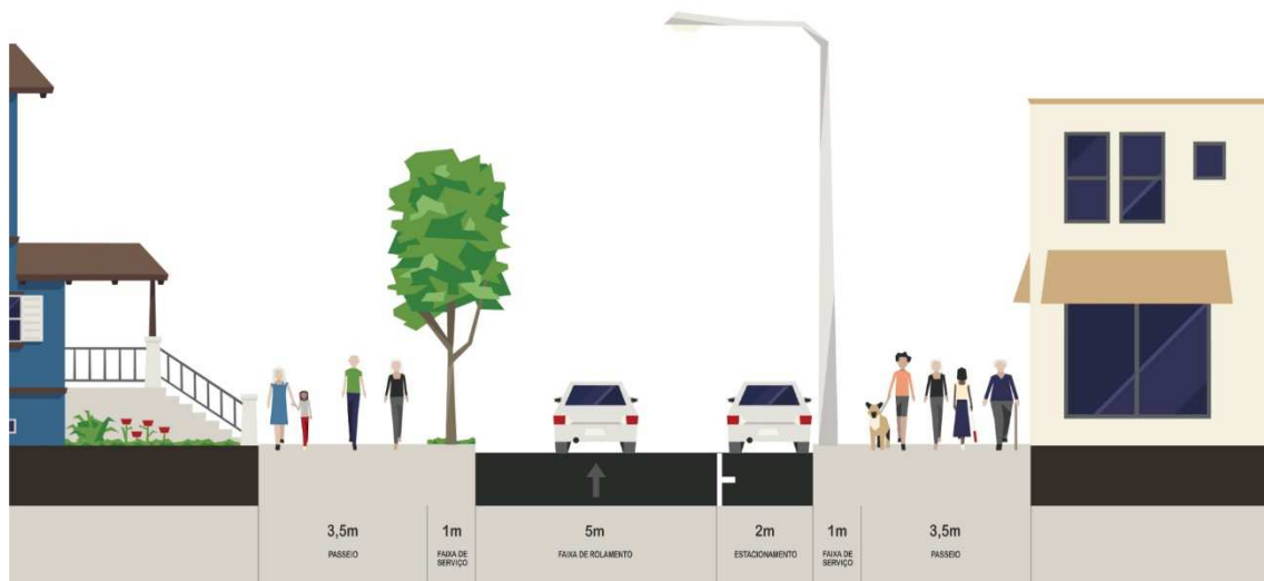
Figura 38: Perfil viário padrão da Via Local - Sentido Único (TIPO 38)
