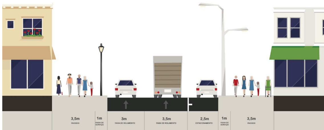
Figura 24: Perfil viário padrão da Via Coletora 2 - Sentido Único (TIPO 24)
