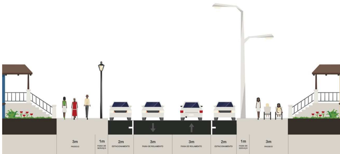
Figura 31: Perfil viário padrão da Via Coletora 2 – Sentido Duplo (TIPO 31)
