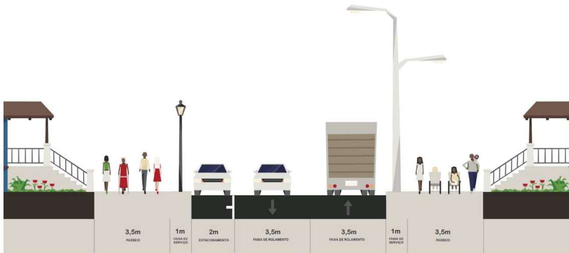
Figura 30: Perfil viário padrão da Via Coletora 2 – Sentido Duplo (TIPO 30)
