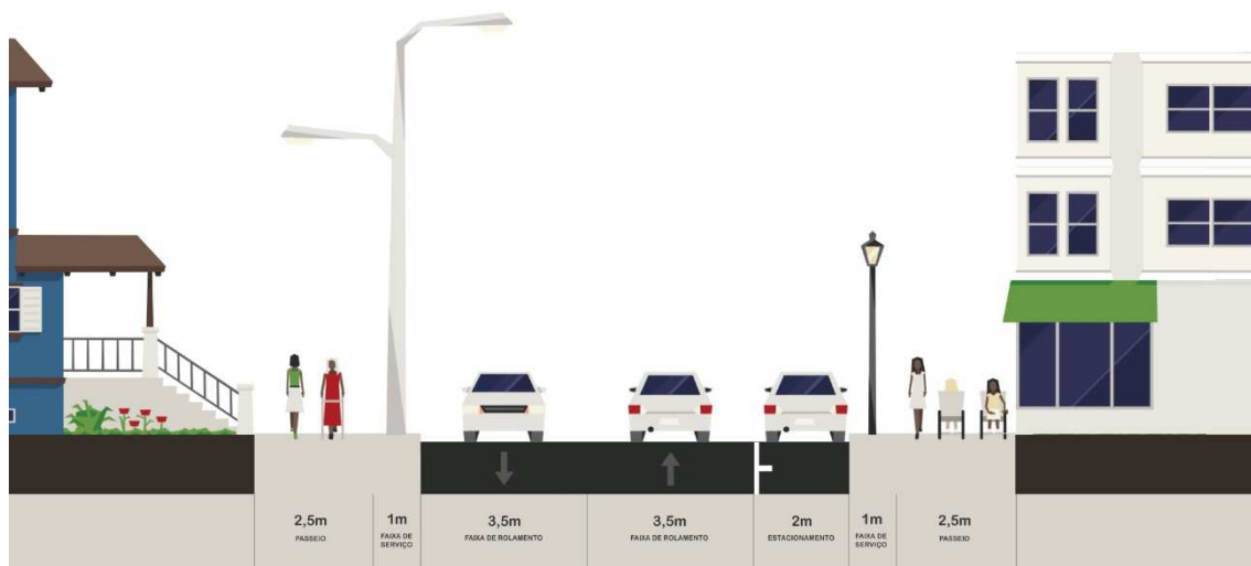
Figura 42: Perfil viário padrão da Via Local - Sentido Duplo (TIPO 42)
