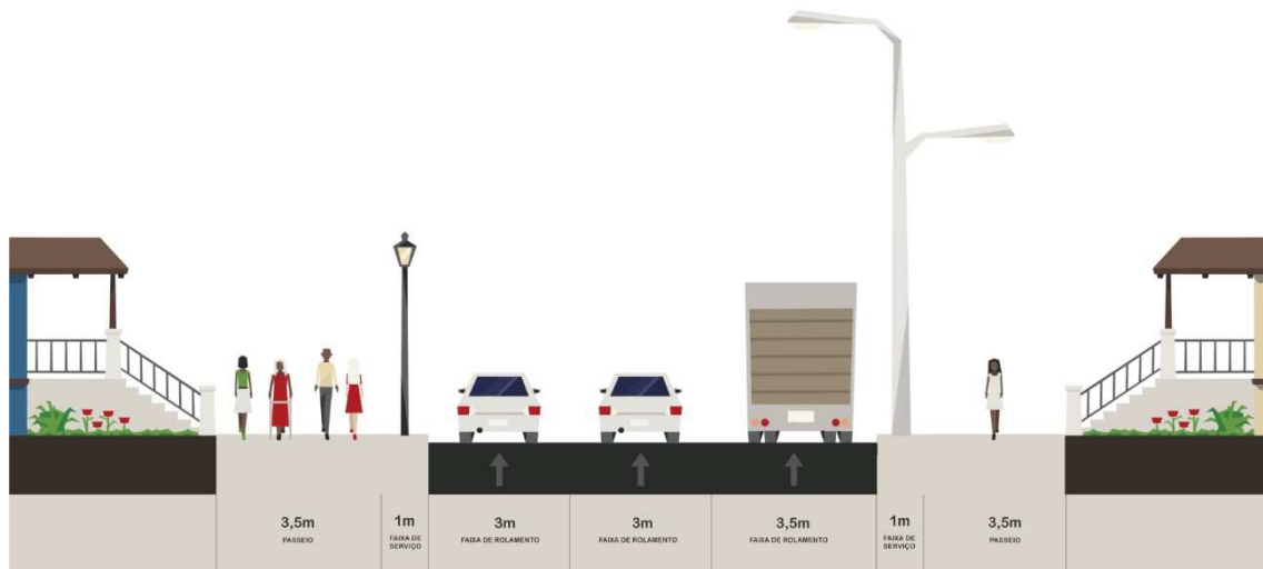
Figura 26: Perfil viário padrão da Via Coletora 2 - Sentido Único (TIPO 26)
