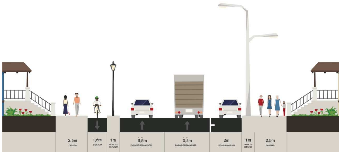
Figura 27: Perfil viário padrão da Via Coletora 2 - Sentido Único (TIPO 27)
