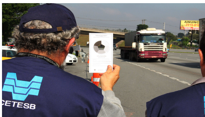
Figura 27 - Representação da escala da escala Ringelman e utilização e utilização da mesma in loco .
