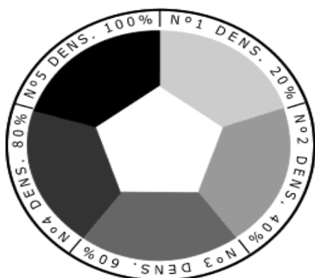
Figura 27 - Representação da escala da escala Ringelman e utilização e utilização da mesma in loco .
