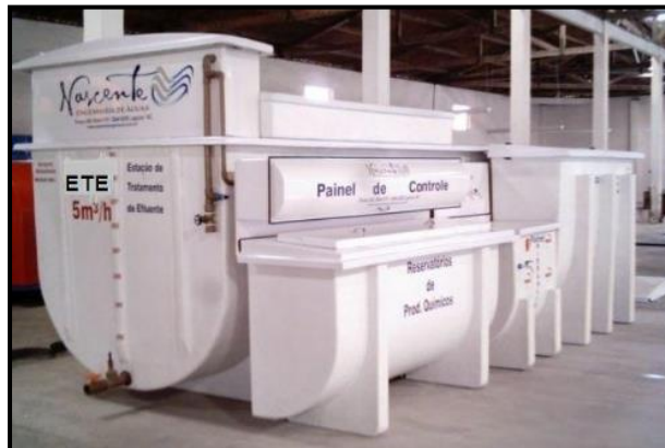
Figura 18 – Modelo do sistema físico-químico que será implantado no empreendimento.
