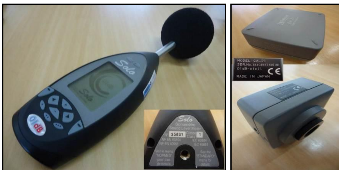
Figura 41 – Medidor de nível sonoro (MINS) e calibrador acústico utilizados.
