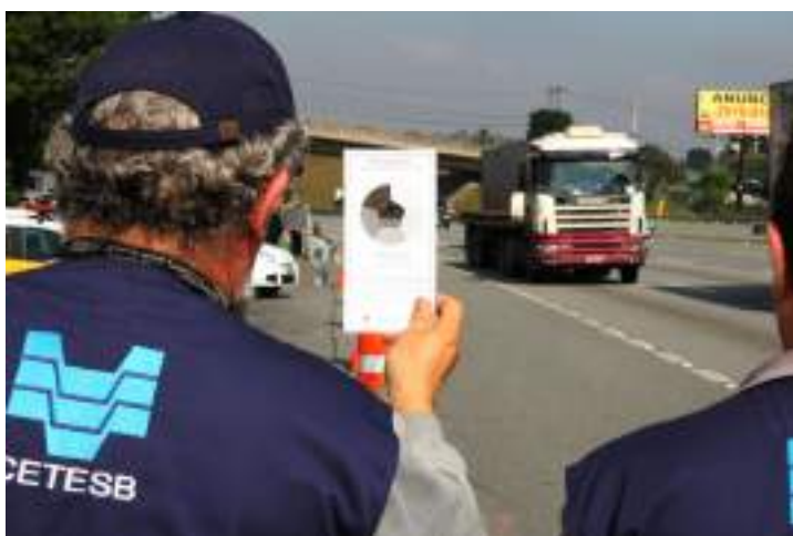
Figura 23 - Representação da escala da escala Ringelman e utilização e utilização da mesma in loco .
