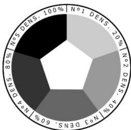
Figura 23 - Representação da escala da escala Ringelman e utilização e utilização da mesma in loco .
