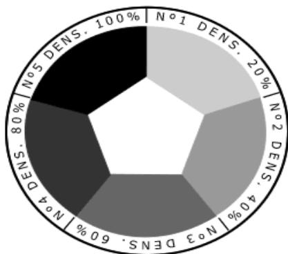
Figura 19: Representação da escala da escala Ringelman e utilização e utilização da mesma in loco .
