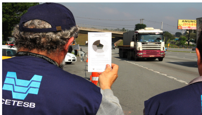
Figura 19: Representação da escala da escala Ringelman e utilização e utilização da mesma in loco .
