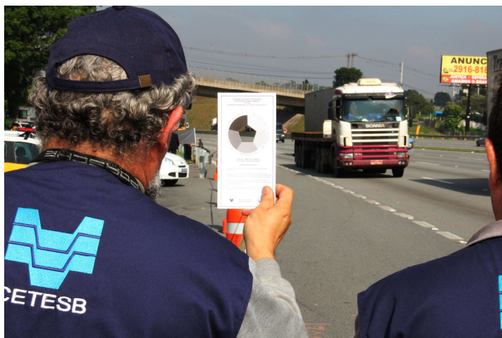
Figura 21: Representação da escala da escala Ringelman e utilização e utilização da mesma in loco .
