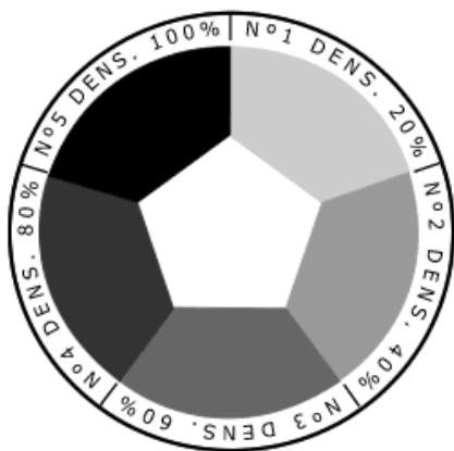
Figura 20: Representação da escala da escala Ringelman e utilização e utilização da mesma in loco .
