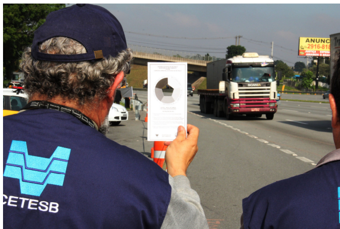
Figura 20: Representação da escala da escala Ringelman e utilização e utilização da mesma in loco .
