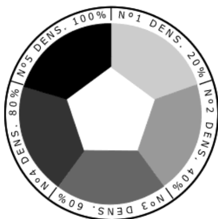
Figura 18: Representação da escala da escala Ringelman e utilização e utilização da mesma in loco .
