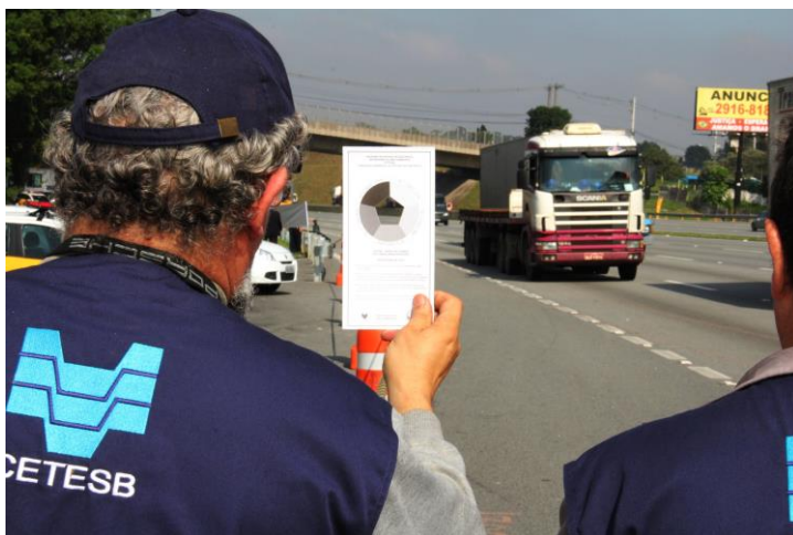
Figura 18: Representação da escala da escala Ringelman e utilização e utilização da mesma in loco .
