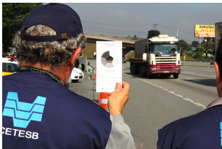
Figura 24: Representação da escala Ringelman e utilização da mesma in loco .
