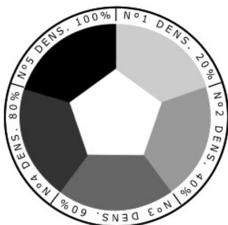
Figura 24: Representação da escala Ringelman e utilização da mesma in loco .
