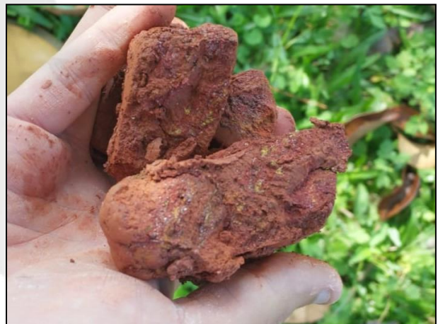
Fotografia 07: Material avermelhado localizado acima da superfície freática sondado na ST-05 (Andes Geologia, 2024).
