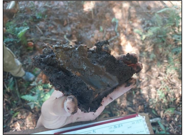
Fotografia 29: Solo residual abaixo do sedimento inconsolidado sondado na ST-09 (Andes Geologia, 2024).
