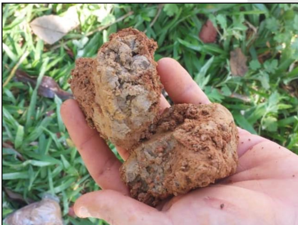
Fotografia 06: Material acinzentado localizado abaixo da superfície freática sondado na ST-08 (Andes Geologia, 2024).
