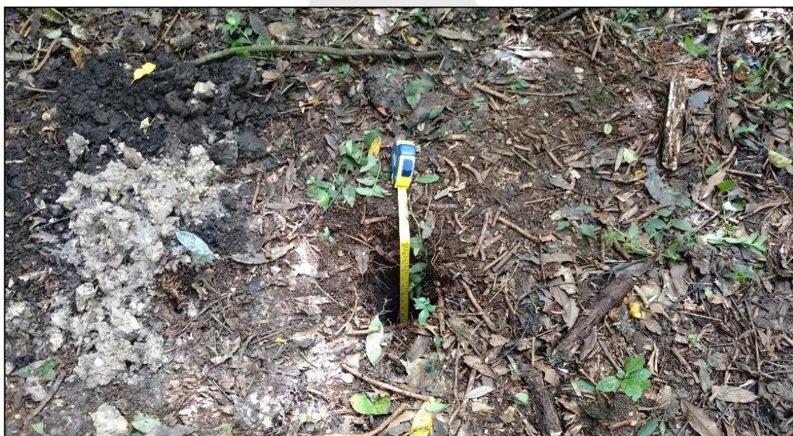
Fotografia 10: Medição do nível freático final (Acervo Andes Geologia).
