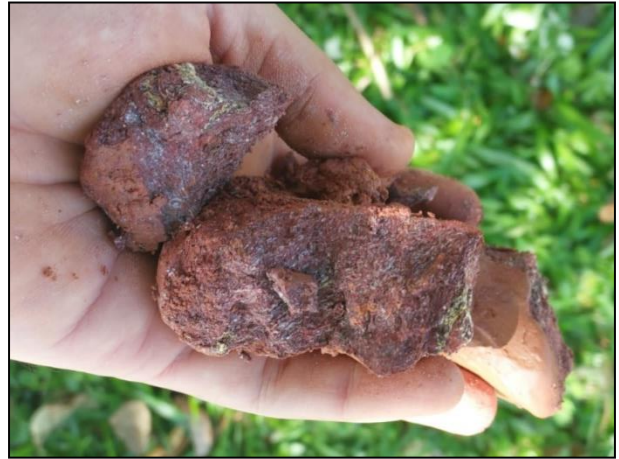
Fotografia 05: Saprólito de Granito-Gnaiss sondado na ST-06 (Andes Geologia, 2024).
