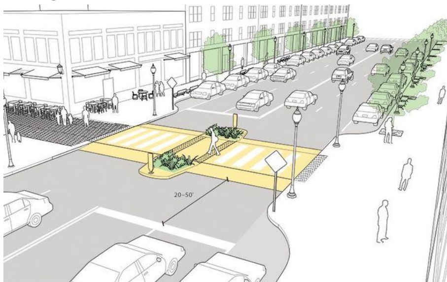
Figura 10: Ilha de Refúgio Associada à Travessia Elevada
