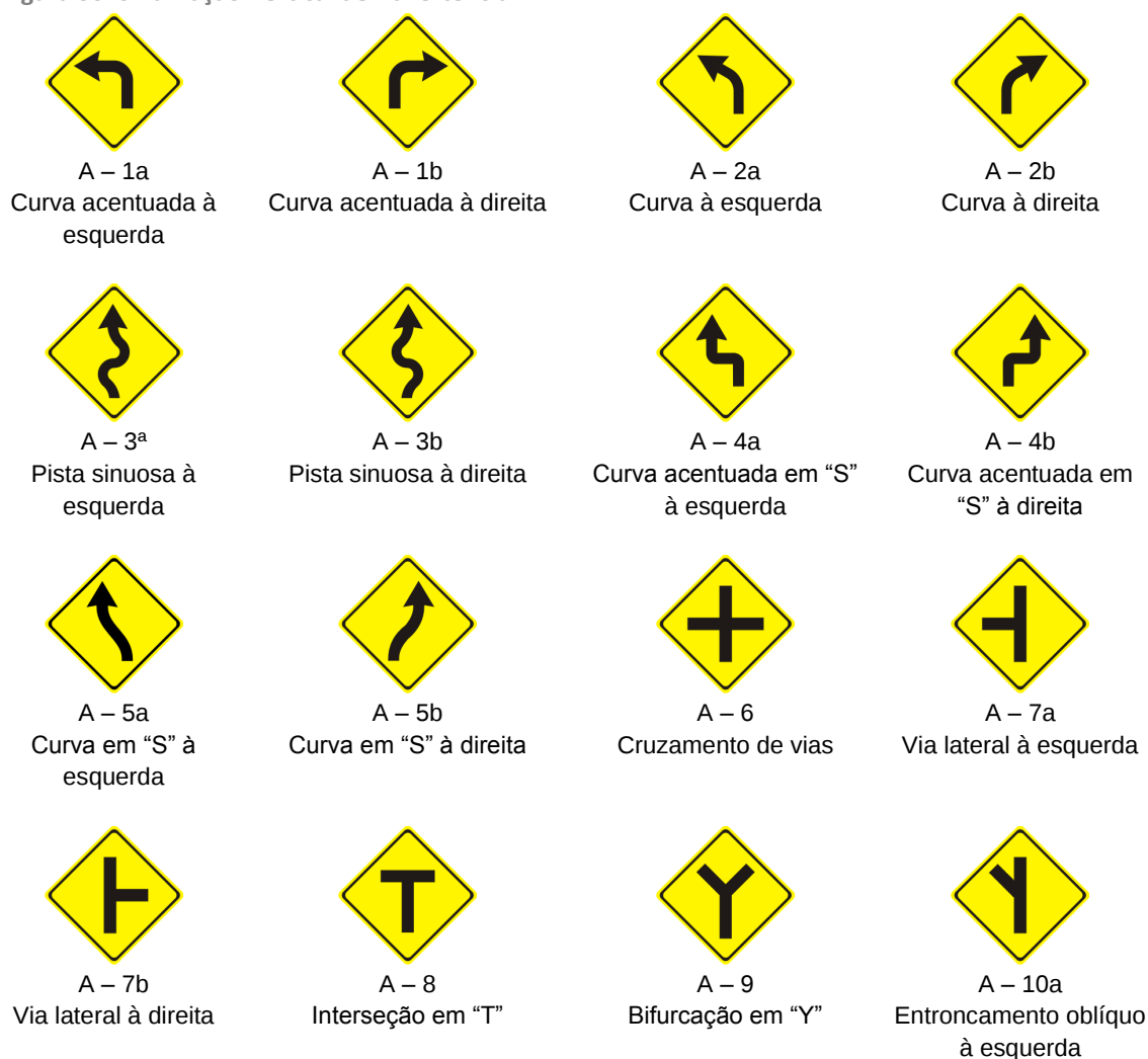
Figura 30: Sinalização Vertical de Advertência
