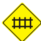
A – 40 Passagem de nível com barreira
