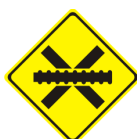
A – 39 Passagem de nível sem barreira
