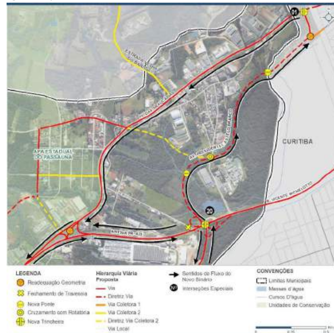
Figura 24: Esquema estrutura viária de conexão entre Avenida das Araucárias e Curitiba.
