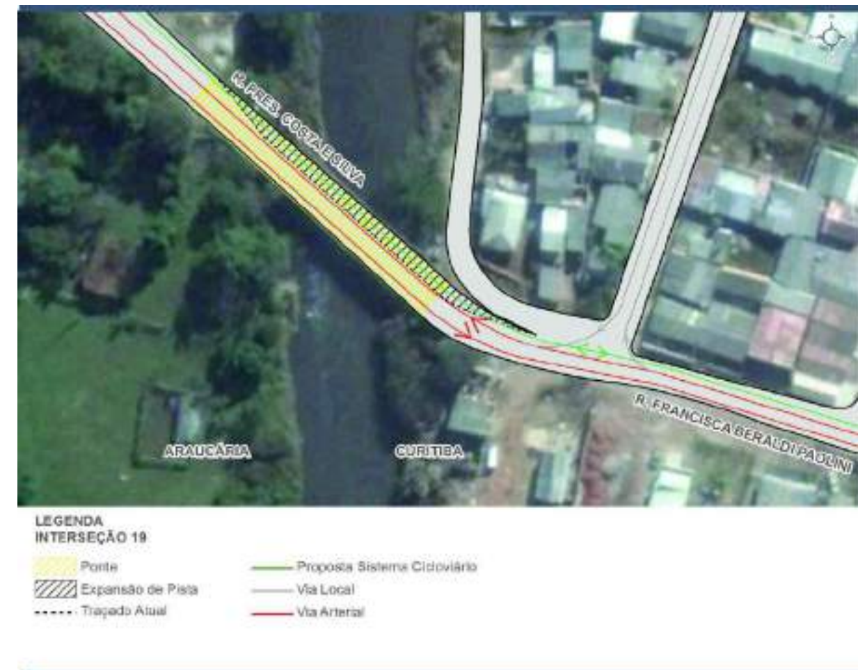
Figura 6: Solução esquemática de proposta de ampliação da capacidade da R. Pres. Costa e Silva.
