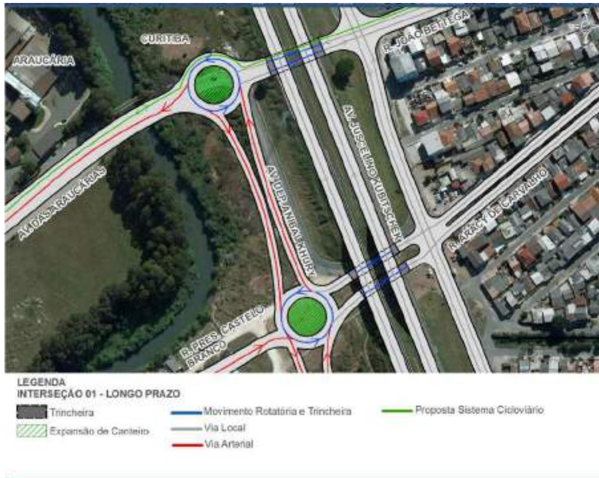
Figura 5: Solução esquemática de proposta de melhoria no traçado geométrico do acesso à Avenida das Araucárias e prolongamento da R. Pres. Castelo Branco, em longo prazo.
