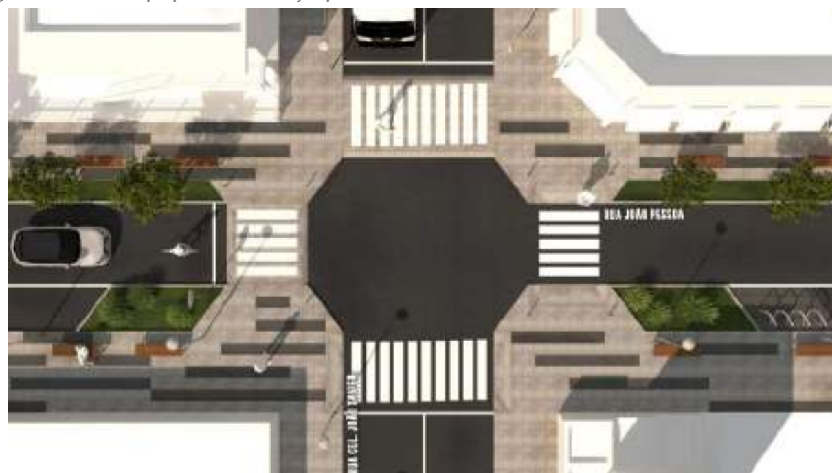
Figura 110: Planta de proposta de interseção para Área Calma.
