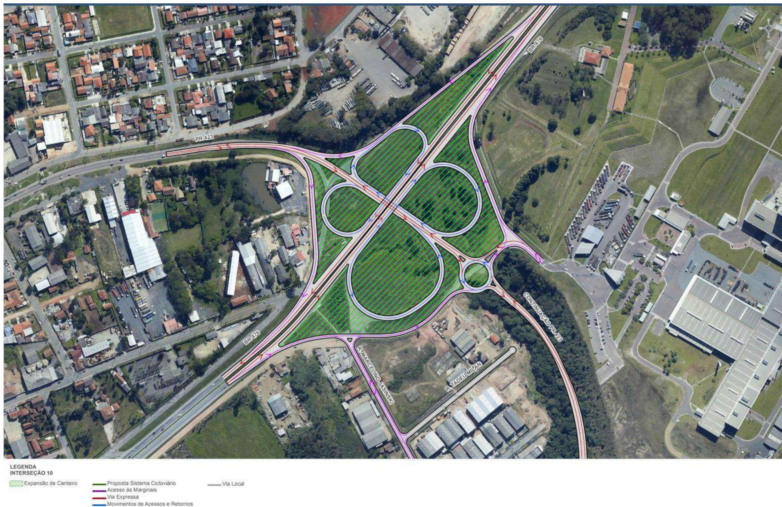
Figura 70: Interseção 10 – Trevo entre PR-423 e BR-476.
