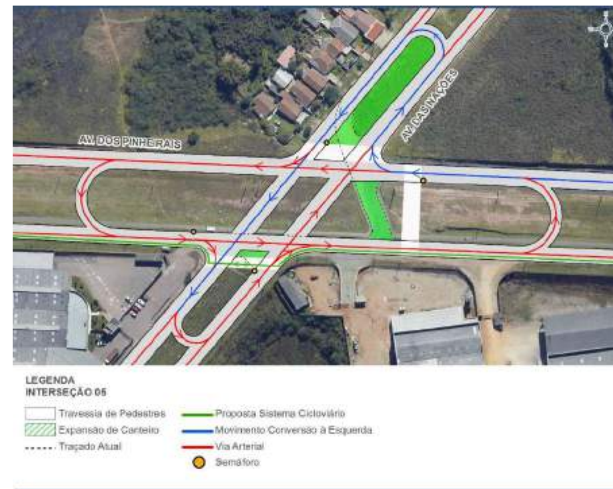
Figura 65: Interseção 05 – Avenida dos Pinheirais com Avenida das Nações.
